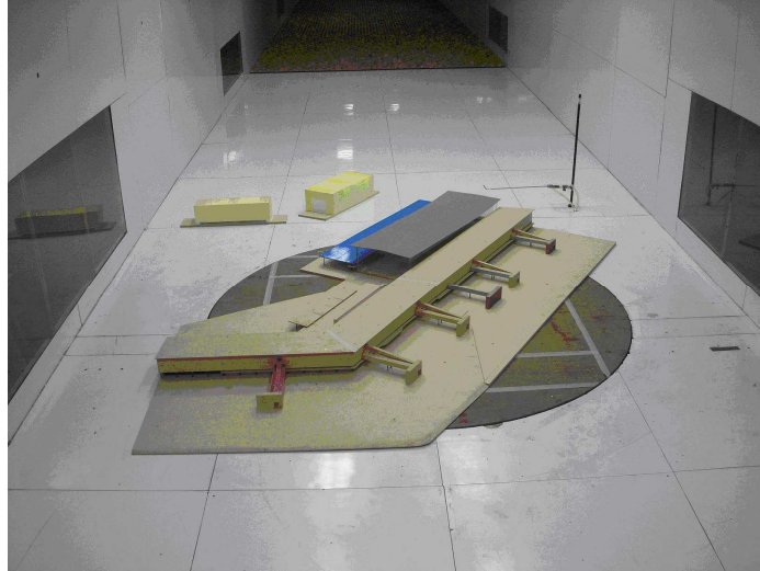
Fig. 6: Maqueta en la cámara de ensayos en la segunda etapa del estudio
