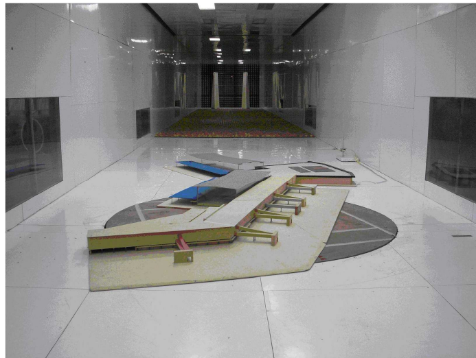
Fig. 7: Maqueta en la cámara de ensayos en la tercera etapa del estudio
