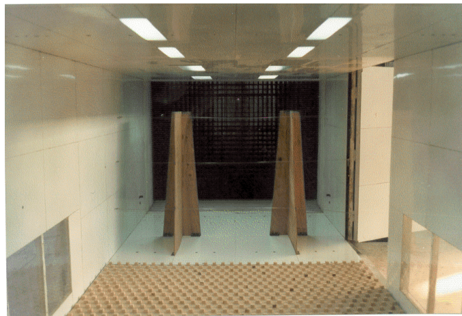
Fig. 2: Equipamiento de simulación de viento natural
